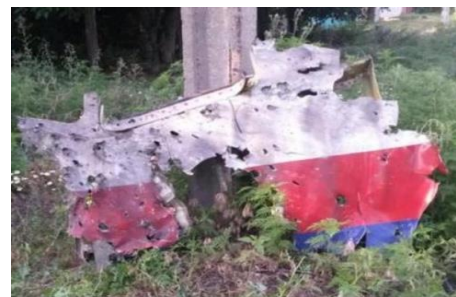
Bild 6: Fragment der Kabine der Boeing 777
