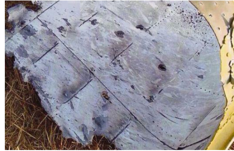
Bild 2: Fragment der Verkleidung der Boeing 777
