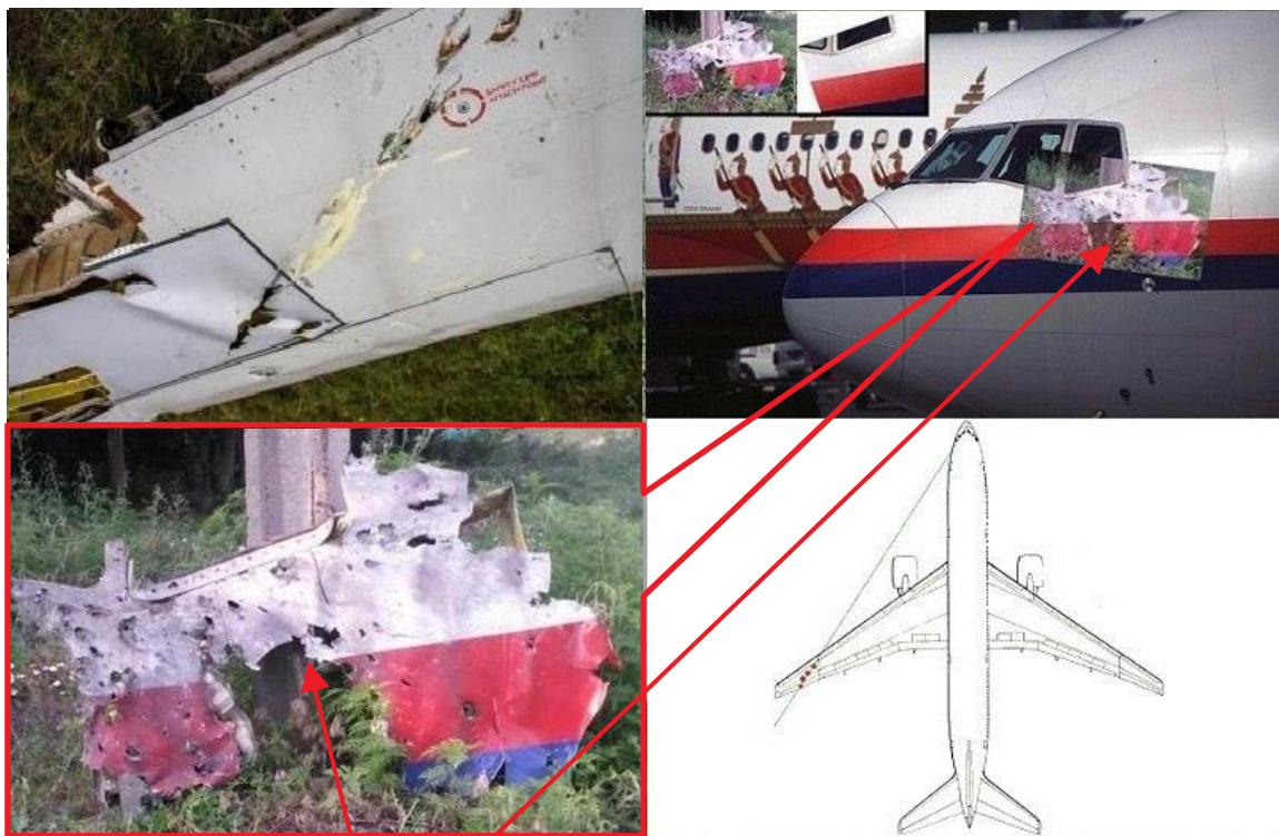
Bild 20: Beschaffenheit der Schäden an der Kabine der Boeing 777
