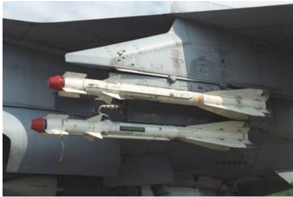
Bild 16: Raketen R-60M, befestigt auf dem äußeren Träger des Flugzeuges
